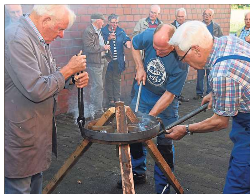
Johannes, Michael und Klemens Stickling (v. l.) von der gleichnamigen Metallbaufirma führten die Teilnehmer der Radwanderung in die frühere Schmiedekunst ein. Sie demonstrierten das Aufziehen eines erhitzten Radreifens.
