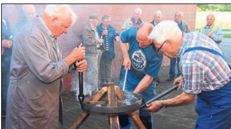
Klemens Stickling und dessen Bruder Johannes Stickling demonstrieren das Aufziehen eines eisernen Radreifens auf ein Holzrad.
